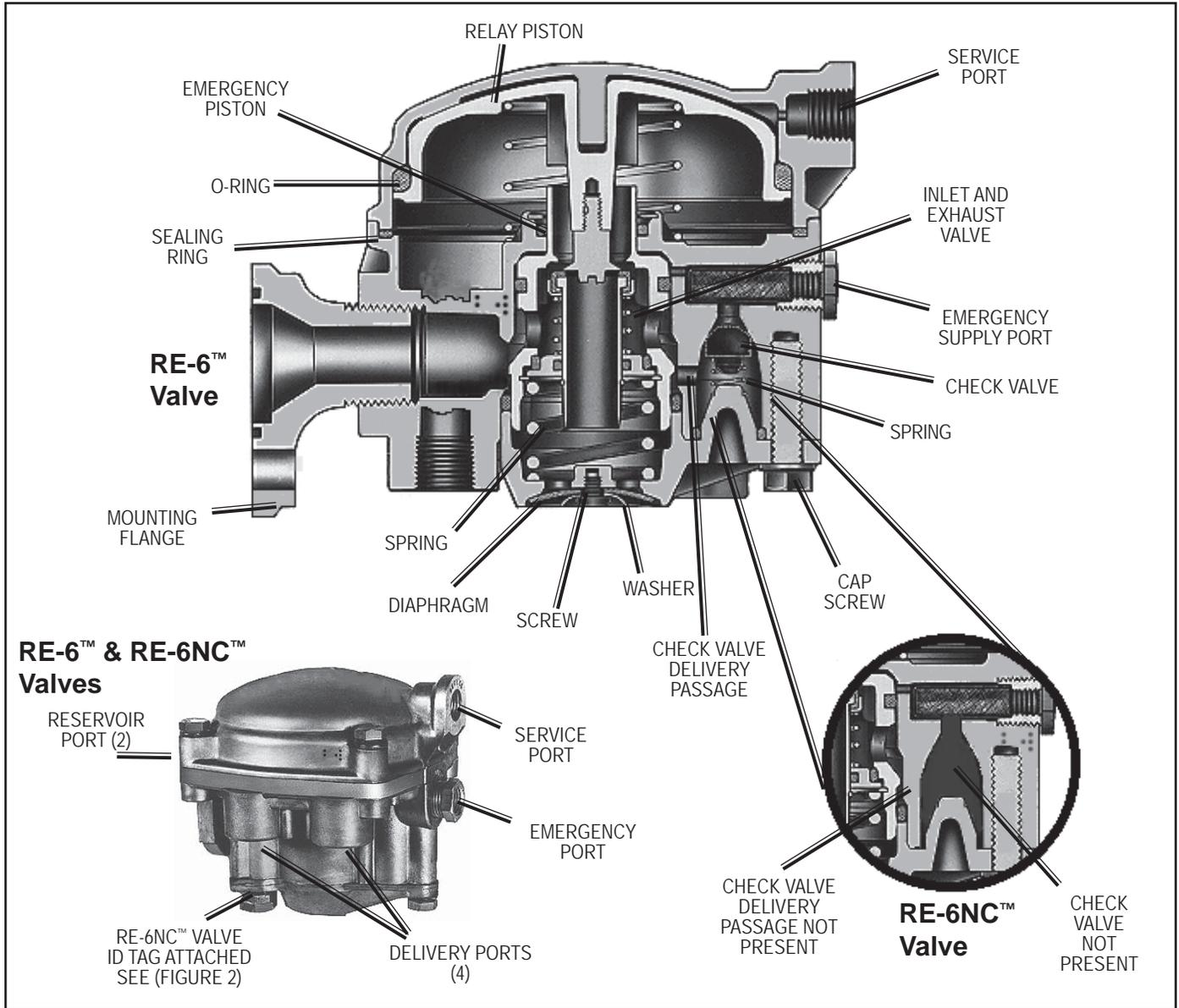
FIGURE 1 RE-6™ & RE-6NC™ RELAY VALVES
