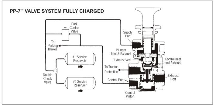
FIGURE 5 - PP-7<sup>™</sup> TRAILER SUPPLY VALVE SYSTEM FULLY CHARGED
